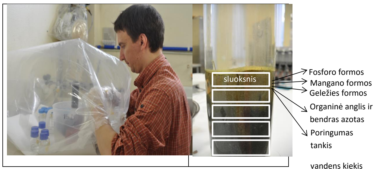
2.5 pav. Nuosėdų mėginių paruošimas bedeguonėje aplinkoje (kairėje) ir nuosėdų kolonėlės supjaustymo schema skirtingoms analizėms (dešinėje).
