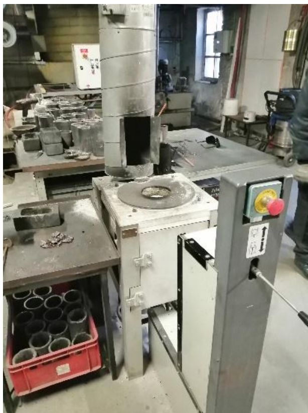
Pav.6. Indukcinio lydymo krosnis su oro nutraukimo sistema
