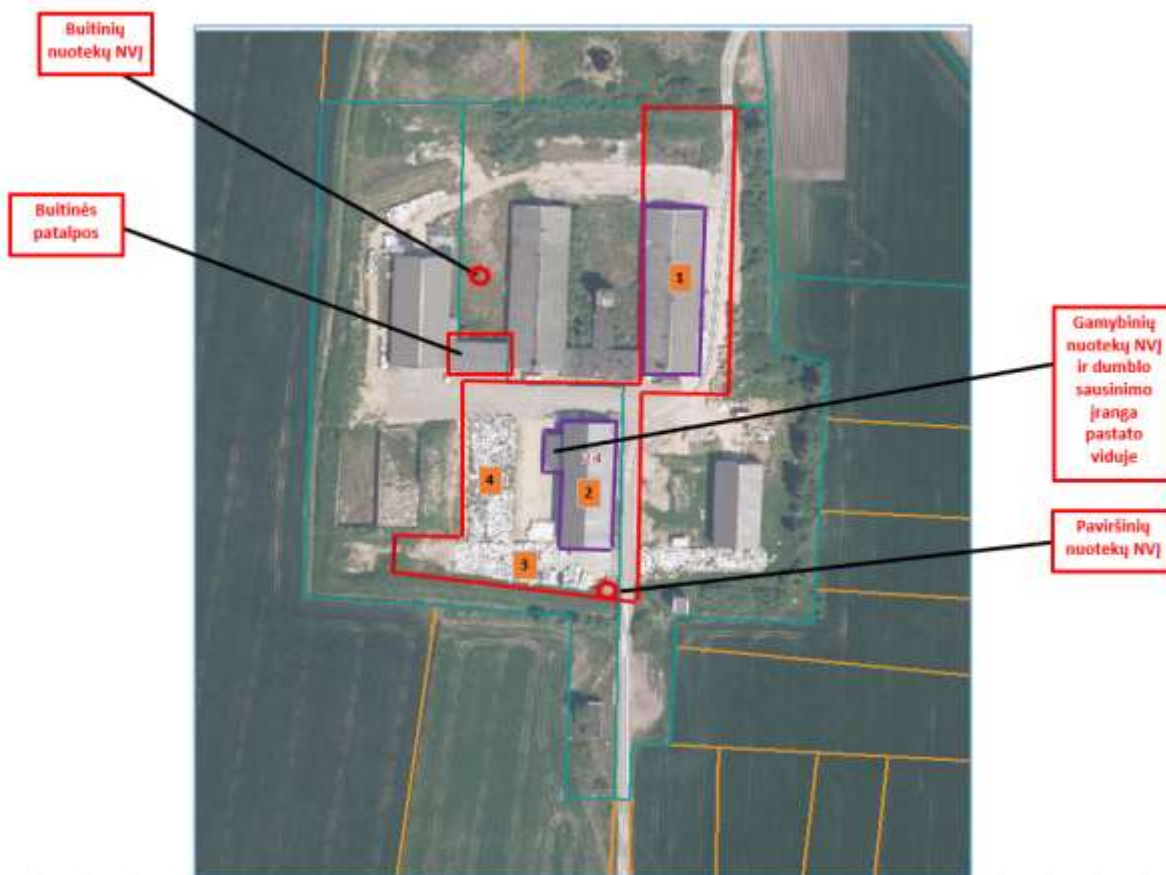
Pav. 1.8-3 gamybinių, buitinių ir paviršinių nuotekų valymo įrenginių bei dumblo sausinimo įrenginio išdėstymo schema Žibučių g. 22 ir Žibučių g. 24 Krekenavos sklypų teritorijose
