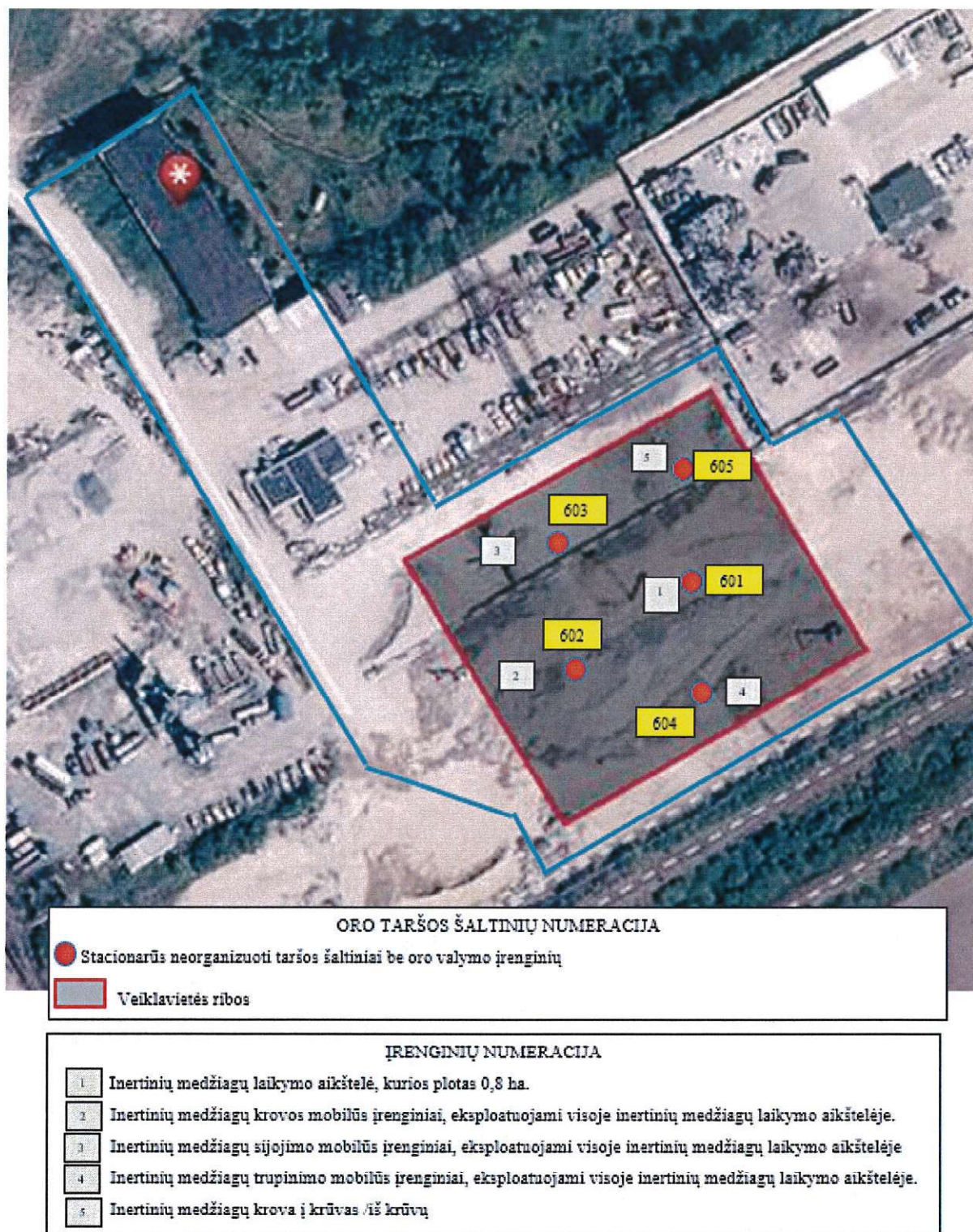
9 pav. Stacionarių oro taršos šaltinių schema
