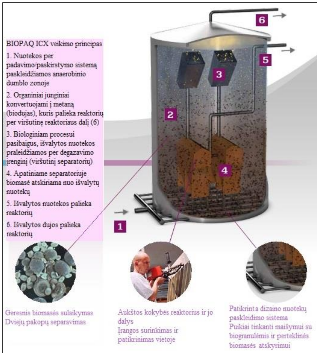
2 pav. Bioreaktoriaus veikimo principinė schema
